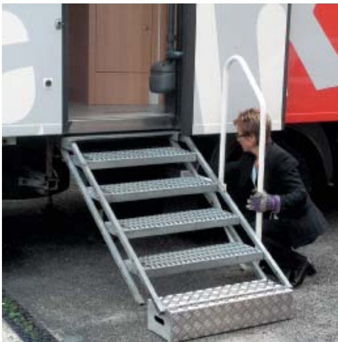
Montieren der Sicherheitsgeländer.
